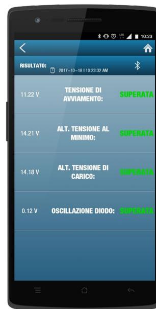
▲ Test del circuito di ricarica e avviamento: Tensione di avviamento, Tensione al minimo, Tensione di carico e oscillazione residua.
