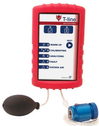
Mini ID R1234yf è un dispositivo per la verifica della purezza del gas nei sistemi di climatizzazione; ne permette infatti il controllo prima di effettuare il servizio su veicolo evitando di contaminare la stazione di manutenzione e ricarica e il gas in essa contenuto. L'utilizzo è molto semplice e guidato in tutte le fasi passo per passo.
