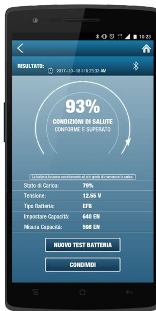
▲ Test di controllo batteria: stato efficienza, stato di carica, tensione e misurazione della corrente di spunto.
