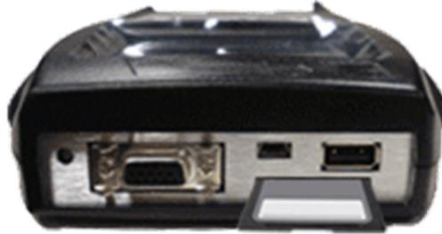
Spegnere lo strumento (nell'esempio un Tester Smart, la procedura è valida per tutti gli strumenti) e rimuovere la scheda di memoria.
