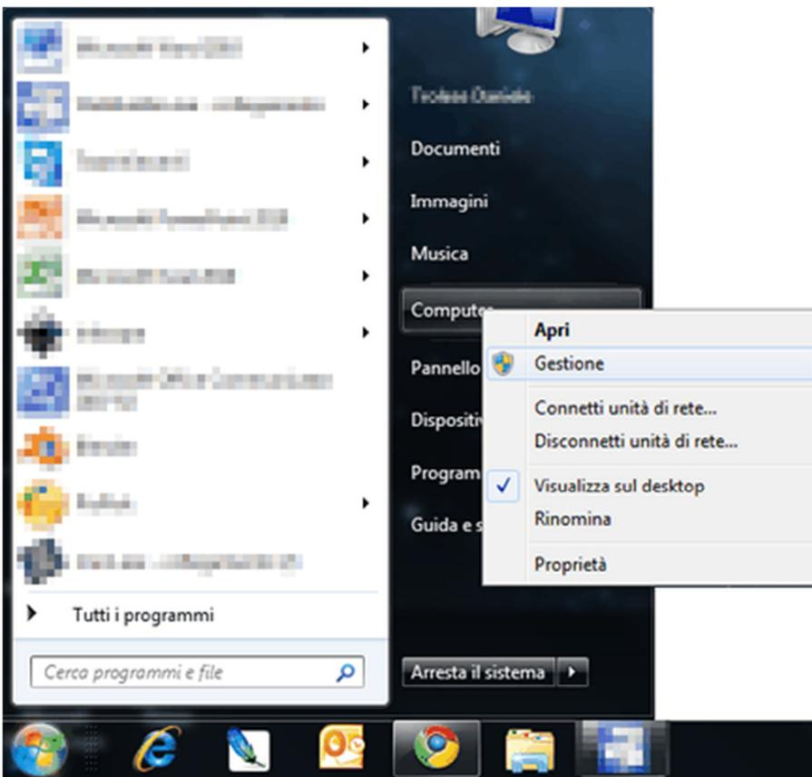
Selezionare il pulsante **Avvio/Start** di Windows, in seguito selezionare (mediante il tasto destro del mouse) **“Computer”** e in seguito selezionare **“Gestione”**.
