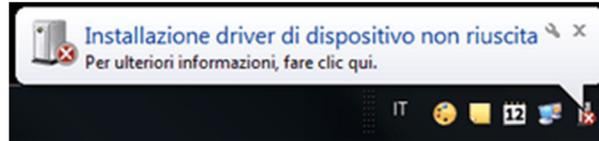
Se compare questo messaggio dopo avere connesso lo strumento utilizzando il cavo USB, significa che la periferica non è stata correttamente configurata.
