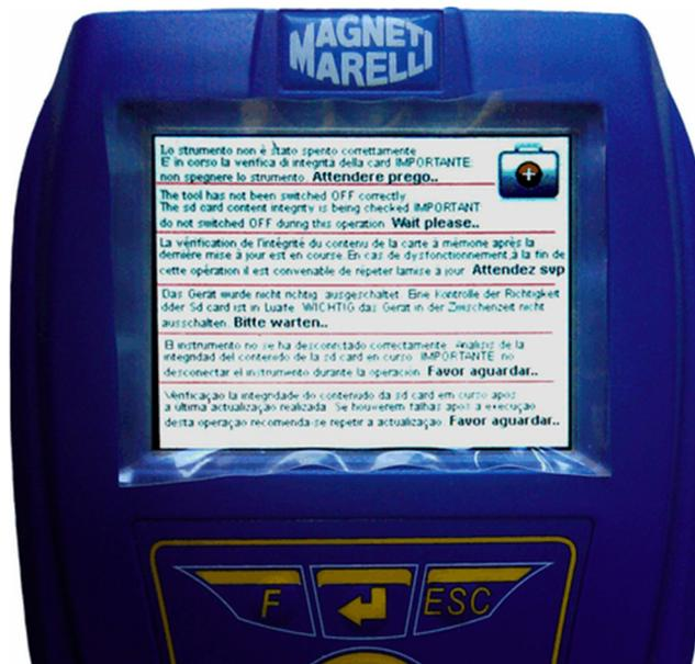
Per evitare danni seri allo strumento è prevista un'operazione di recupero della scheda SD in seguito ad uno spegnimento imprevisto/accidentale.
