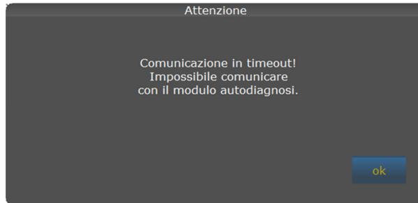
Se sullo schermo del PC compare un messaggio come quello della figura, significa che il modulo **Bluetooth non sta comunicando** con il computer.
