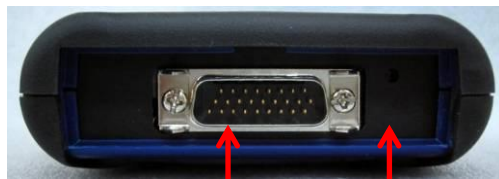
1. Connecteur de câble OBD 7. Voyant d'état de diagnostic
