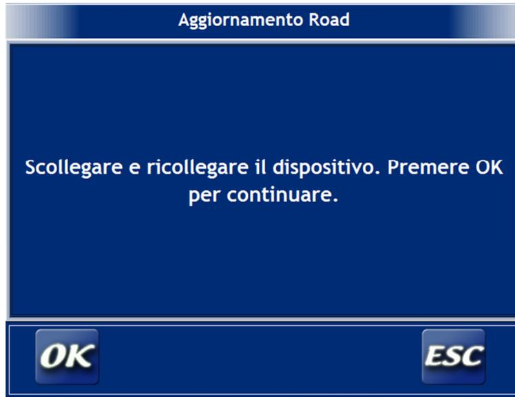
Durante la fase di disconnessione e di connessione, ricordarsi di attendere che il computer emetta il classico suono a conferma dell'avvenuta operazione di connessione e disconnessione.
